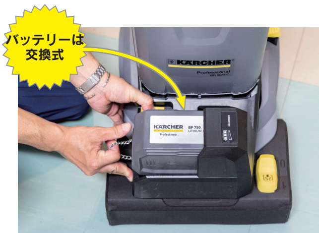
写真2 バッテリーが内蔵式ではないため、予備バッテリーを用意しておけば、十分な稼働時間を確保することができる
